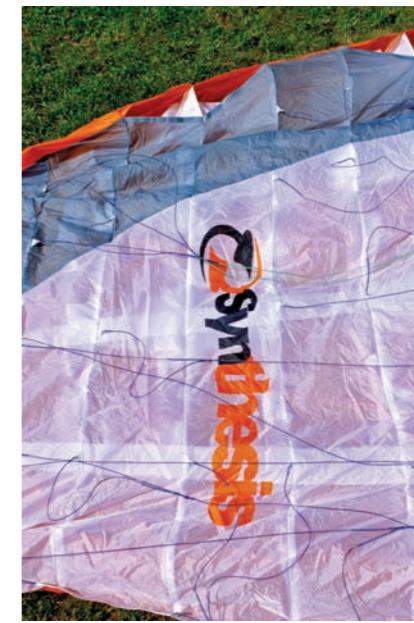
Les cellules fermées améliorent la circulation de l'air au bord d'attaque. Cela contribue à la rigidité des caissons et donc à celle de l'aile.
